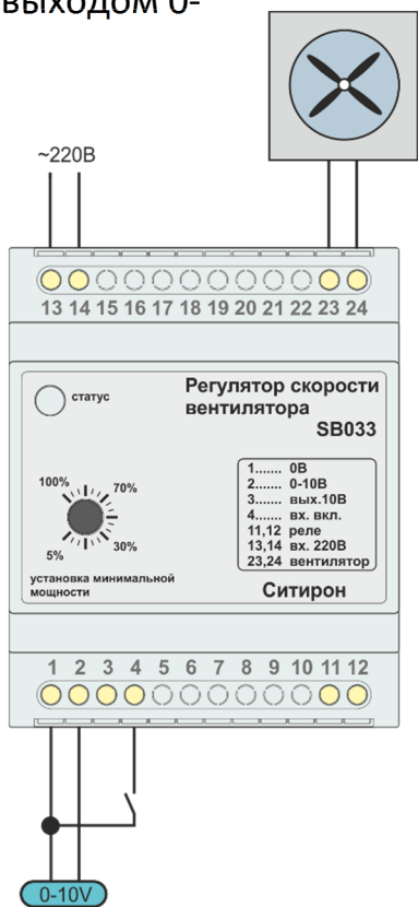
Схема 3 Управление внешним сигналом 0-10В от любого контроллера с выходом 0-10В
